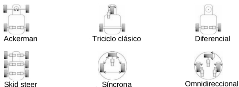
Figura 3.2: Diferentes configuraciones de locomoción.
