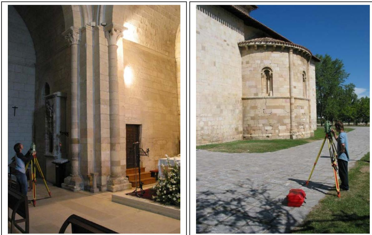
Para la realización de las medidas topográficas se utilizó una estación Leica TCR 307, el certificado de calibración de la estación puede consultarse en el correspondiente anexo, siendo las características principales:
