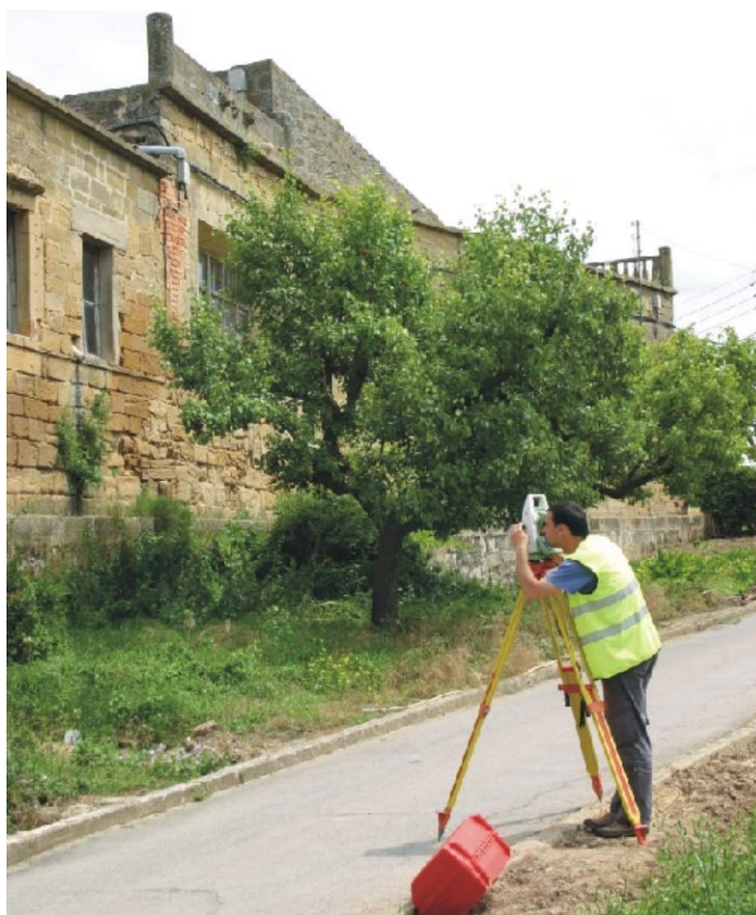
Fig. 3. Fase de toma de datos topográficos mediante estación dotada de medida directa de distancias.
