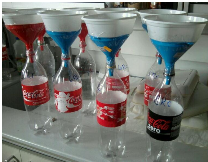
Fig.3. Botellas con embudos y bandeja empleados para el experimento de campo.
