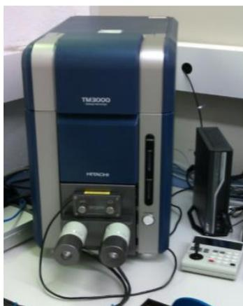
***Figura 12. Microscopio de barrido Hitachi TM3000***
