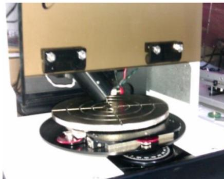
**Figura 11.** Perfilómetro KLA Tencor D-100
