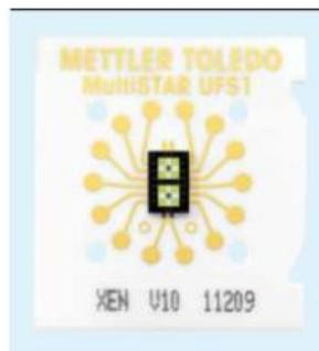
*Figura 14. Chip sensor del Flash DSC 1*
