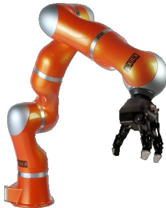
Ilustración 34: Mano robótica acoplada a Lwr utilizando los cables internos del robot
