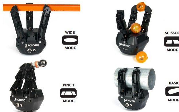
Ilustración 32: Diferentes modos de agarre ajustables para cada tipo de objeto
