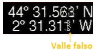
Fig. 3.4: Valle falso generado debido al desfase en la grabación, el cual genera problemas en la segmentación.
