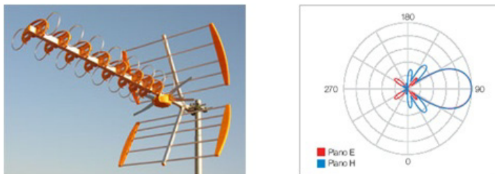
Figura 3.8. Imagen y diagrama de radiación de la antena Televés Ref. 1125
