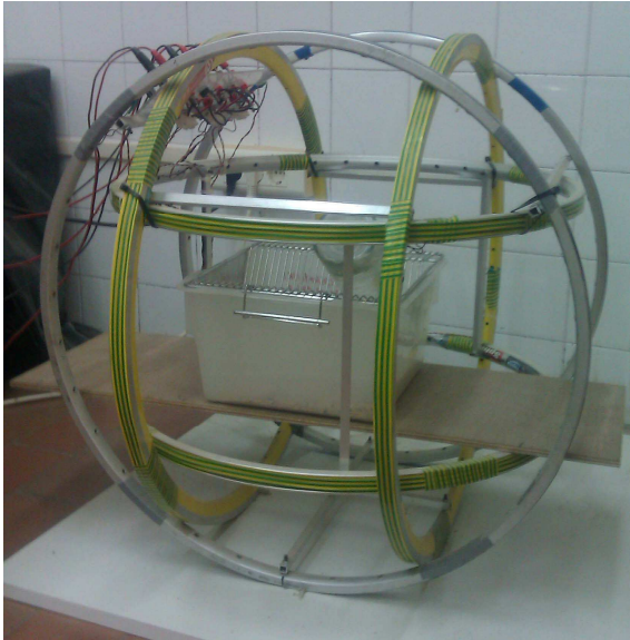
Fig. 2. Fotografía del equipo de estimulación magnética. Se observa que está formado por 3 pares de carretes Helmholtz, orientados en las direcciones X, Y y Z, respectivamente.
