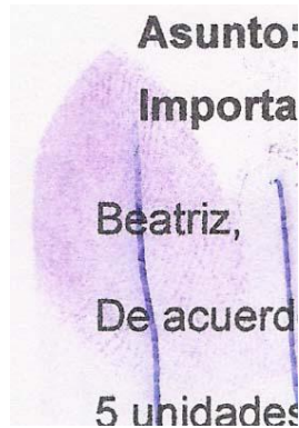
Fig. 4.36. Huella dactilar sobre cruzamiento revelada con una solución de ninhidrina en 2-propanol.
