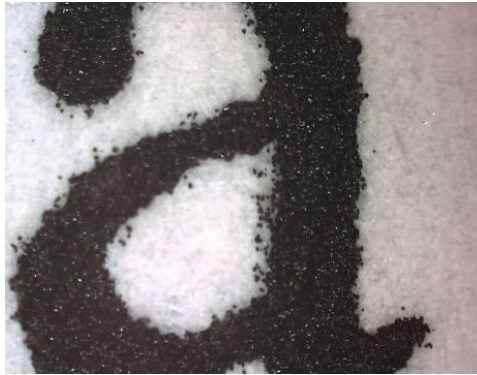
Fig. 4.12. Imagen de una letra “a” impresa con una impresora láser, 60X.
