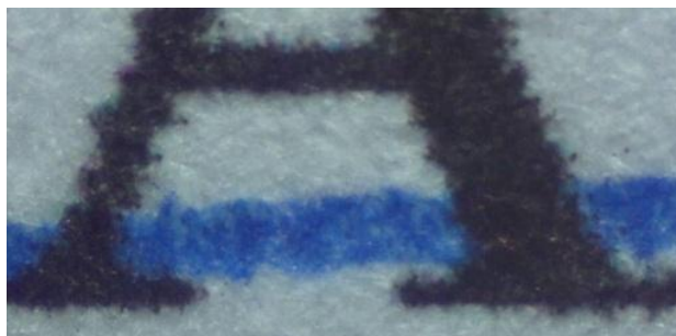
Fig. 4.7. Imagen de un cruce heterogéneo en el que intervienen un útil de punta fluida y un trazo de impresora de chorro de tinta.
