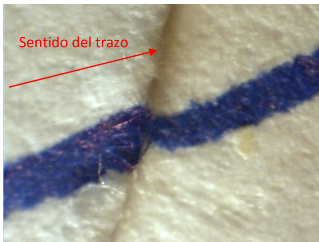
Fig. 4.2. Cruzamiento de un trazo de bolígrafo con el exterior de un dobléz en el papel. 140X.
