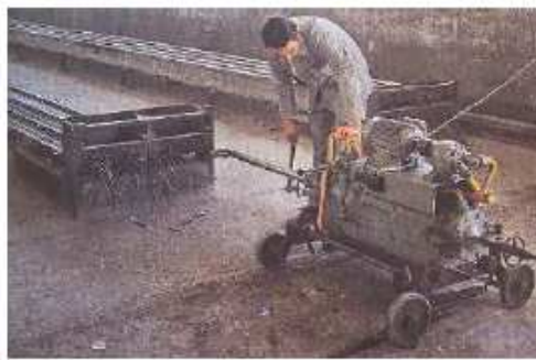
A la izquierda, ficha de características técnicas del forjado mediante soviguetas de hormigón pretensado "AEDIUM-Z", fabricadas en Pamplona. Arriba a la derecha, imagen de un forjado realizado con viguetas "AEDIUM-Z" y, debajo de ella, proceso de tensado de armaduras realizado en uno de los talleres de la empresa. Ficha y fotografías extraídas del "Catalogo AEDIUM de 1967".
