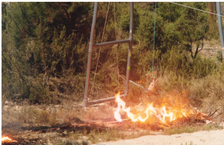
Figura 2.1.Falta de alta impedancia
