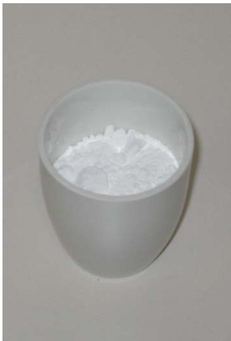
Figura 104: Imagen del sólido obtenido en la calcinación
