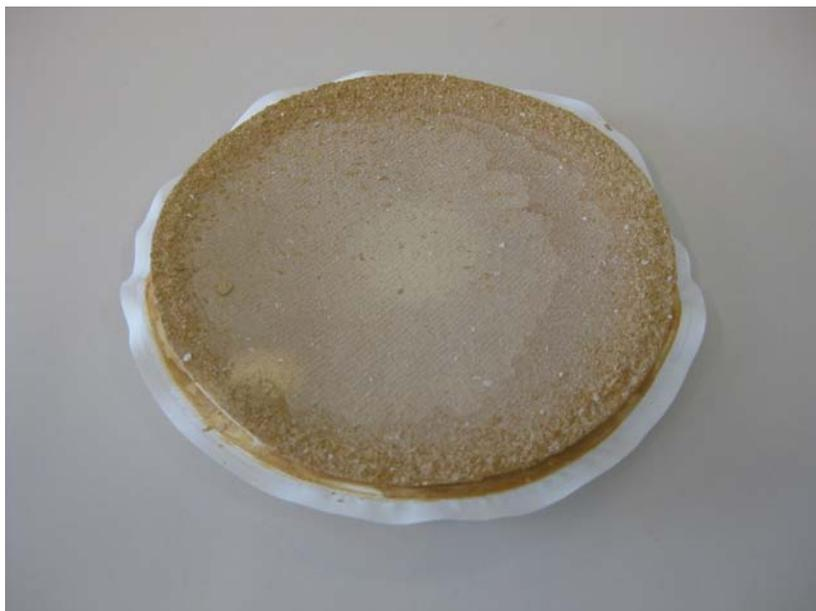
Figura 68: Imagen del residuo sólido obtenido en la oxidación de una lejía clorhídrica
