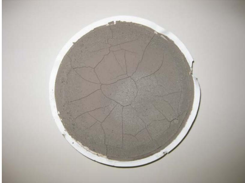
Figura 55: Imagen del residuo sólido obtenido en una lixiviación clorhídrica
