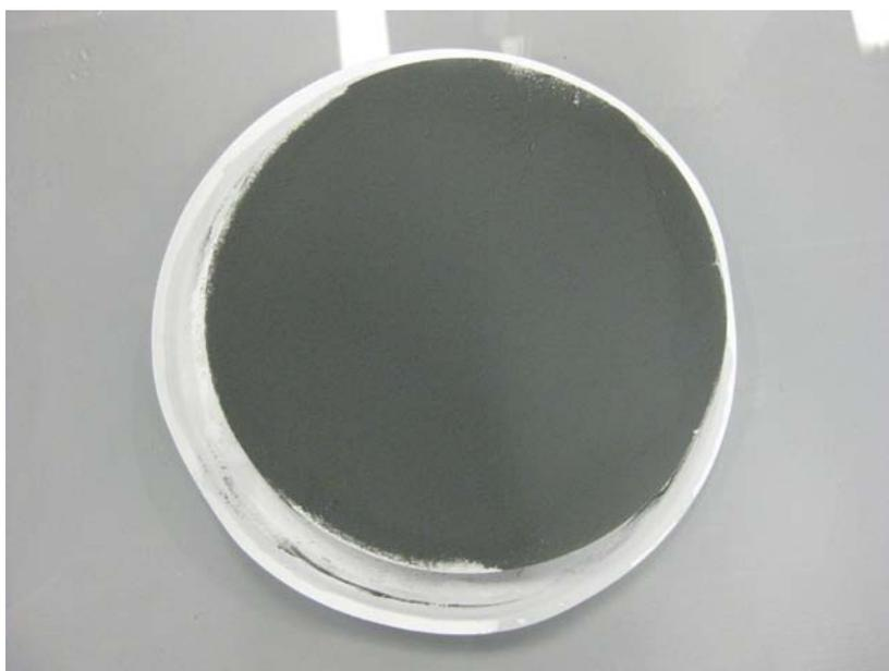
Figura 87: Imagen del residuo sólido obtenido en la cementación de una lejía sulfúrica oxidada con agua oxigenada y bióxido de manganeso
