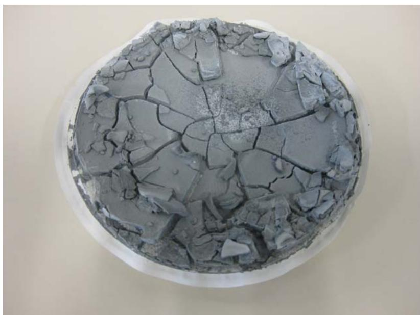
Figura 84: Imagen del residuo sólido obtenido en la cementación de una lejía sulfúrica oxidada con agua oxigenada
