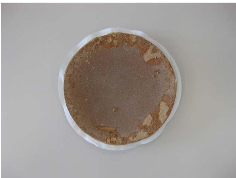
Figura 71: Imagen del residuo sólido obtenido en la oxidación de una lejía sulfúrica en la que se utiliza  $H_2O_2$  como único agente oxidante
