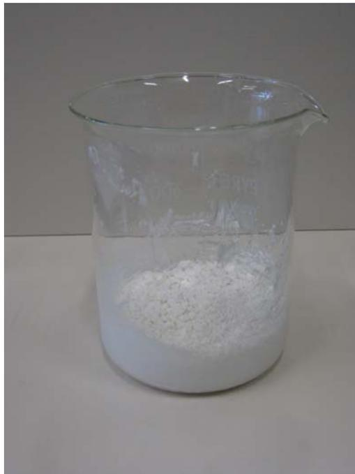
Figura 103: Imagen del sólido obtenido en la precipitación
