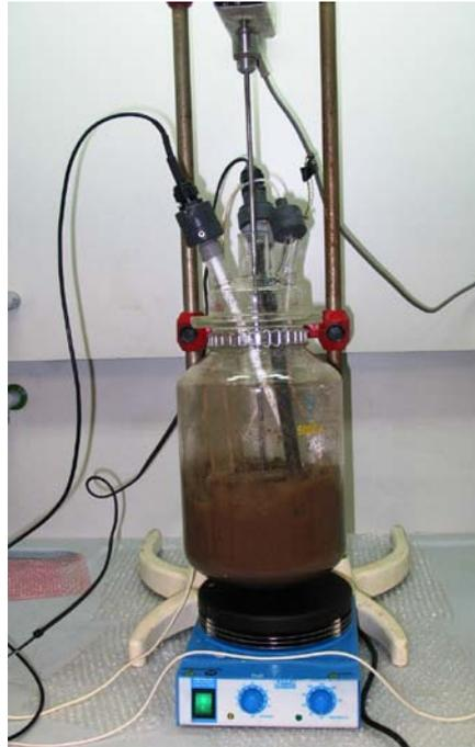
Figura 20: Reactor de vidrio utilizado en la lixiviación
