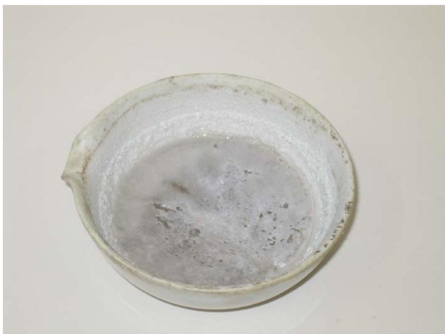
Figura 118: Imagen del sólido obtenido en la segunda etapa de evaporación
