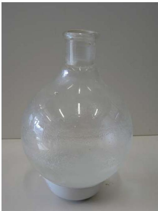
Figura 113: Imagen del sulfato de zinc monohidratado obtenido en la evaporación
