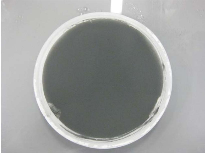
Figura 81: Imagen del residuo sólido obtenido en la cementación de una lejía clorhídrica
