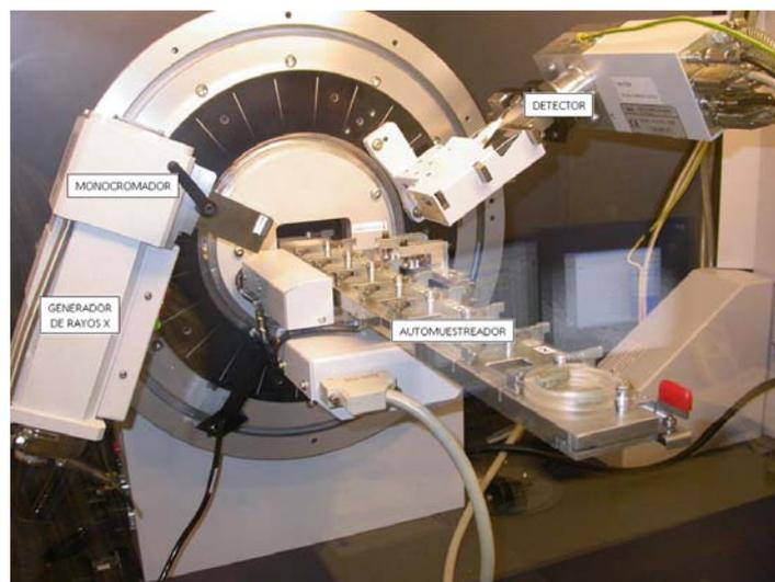
Figura 37: Difractómetro de rayos X
