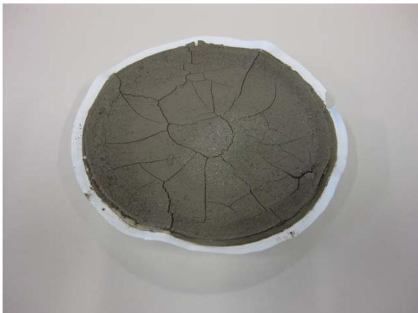
Figura 58: Imagen del residuo sólido obtenido en una lixiviación sulfúrica
