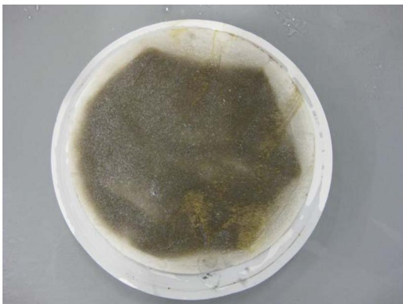
Figura 74: Imagen del residuo sólido obtenido en la oxidación de una lejía sulfúrica en la que se utilizan  $\text{MnO}_2$  y  $\text{H}_2\text{O}_2$  como agentes oxidantes
