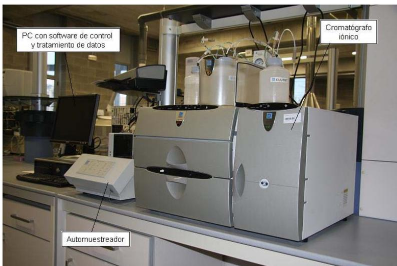
Figura 36: Cromatógrafo iónico utilizado en los análisis
