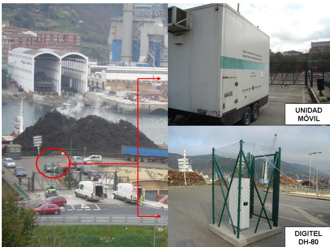
Figura 5.3. Vista de la localización de la zona de muestreo, la unidad móvil y el muestreador de alto volumen ubicados en MOLINAO, Puerto de Pasaia.
