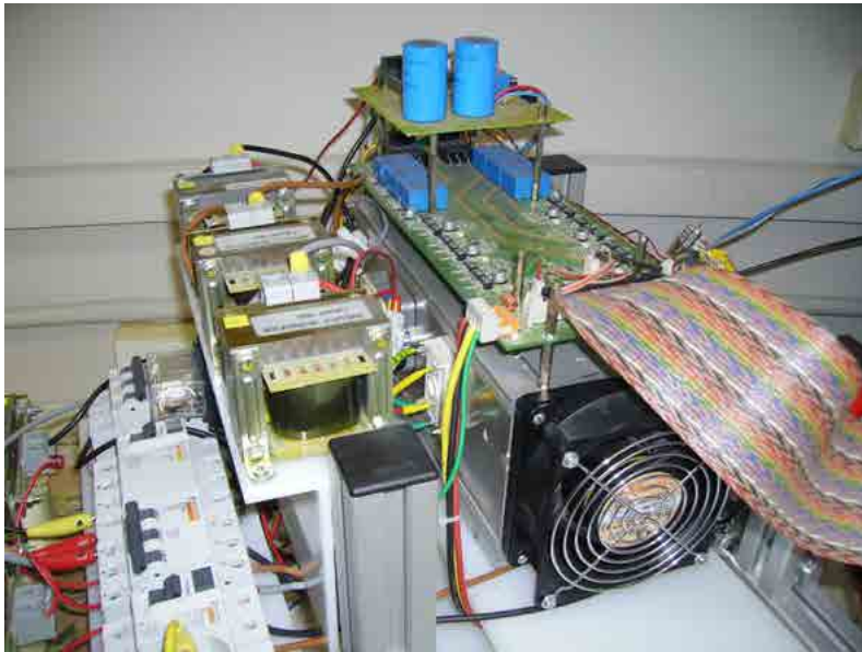
7.11 irudia. Tesian erabilitako 7.5 kW-etako MCaren prototipoa.
