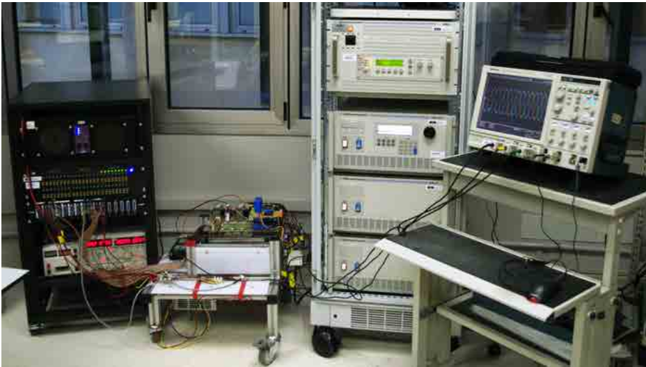
7.19 irudia. Plataforma esperimental: 7.5 kW-etako MCaren prototipoa, RL karga trifasikoarekin konektatuta eta RT-Lab eMEGAsim denbora errealeko gailu digitalaren bidez kontrolatuta.
