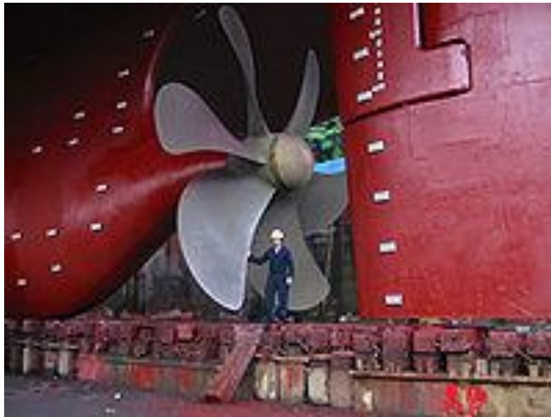
Figura 1.7. Hélice con sentido de giro a la derecha en un navío moderno.
