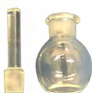
Figura I.9. Fotografía de un picnómetro. Se muestra, a la izquierda, el tapón esmerilado y, a la derecha, el recipiente de vidrio.
