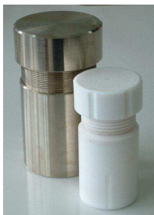
Figura B.1. Recipiente de teflón y carcasa de acero empleados en la síntesis a presión y temperatura moderada.
