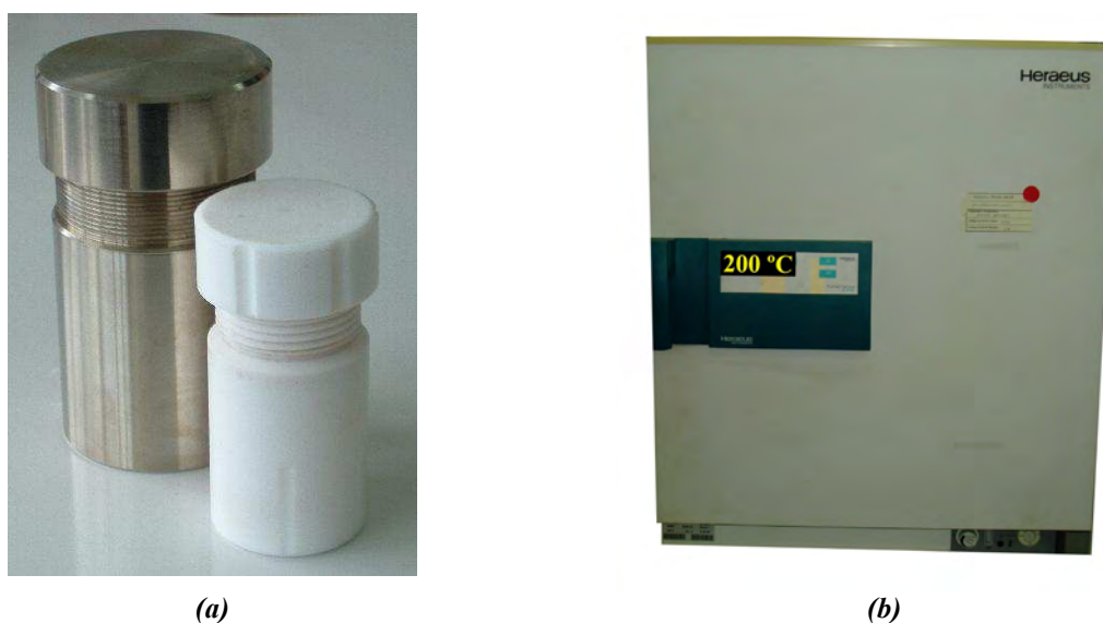
Figura I.1. (a) Recipiente de teflón de 50 ml y carcasa de acero empleados en la síntesis. (b) Estufa utilizada para calentar los recipientes de reacción.
