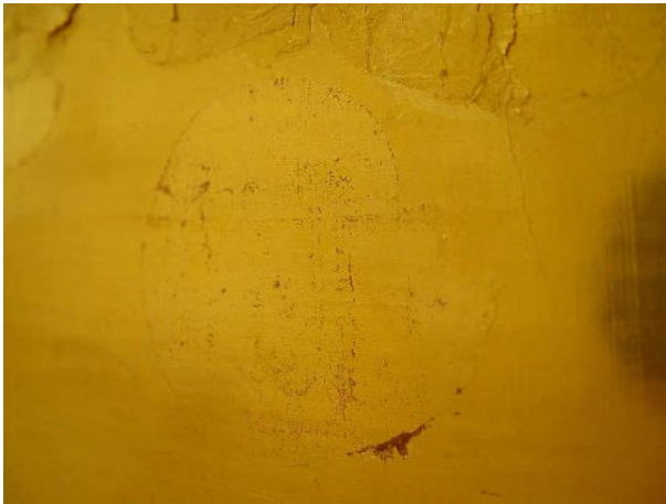
Fig. V.6.- Se aprecia la diferencia de coloración del oro en la zona donde se encontraba un “círculo” ya totalmente perdido. Asimismo, aparecen lagunas debidas al desprendimiento de la hoja metálica que dejan ver el bol de la preparación.
