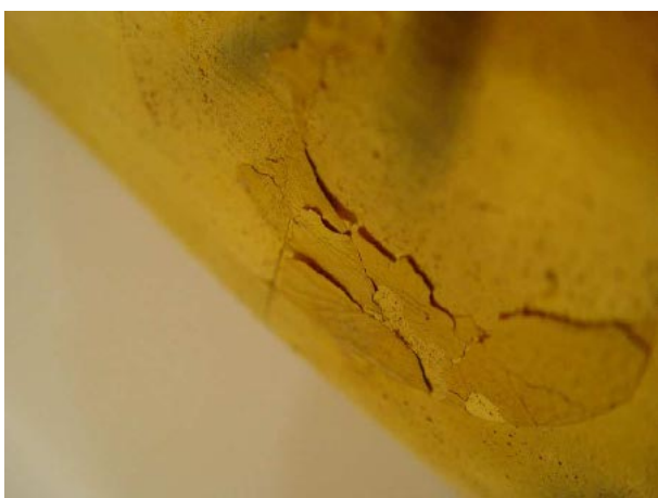
Fig. V.5.- Imagen cenital que muestra la falta de adhesión del oro (a punto de desprenderse) que configura la zona inferior de uno de los “círculos”. La parte superior del mismo ya ha desaparecido.
