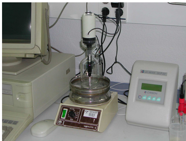
Figura 3.5. Esquema y fotografía del respirómetro ORION de medida continua.
