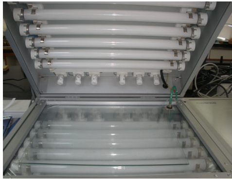
7.25 irudia. Zirkuitu inprimatu bat bi aurpegietatik intsolatzeko gailua.
