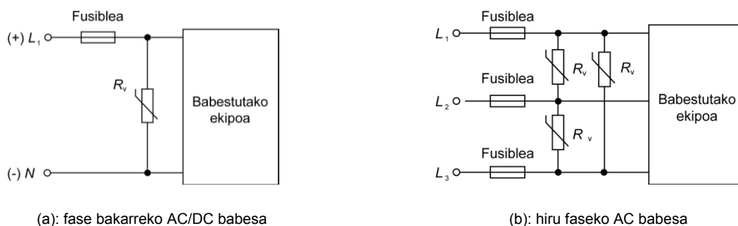
2.52 Irudia: Ekipo elektriko eta elektronikoak kanpotiko gaintentsioengandik babesteko muntaiak.
