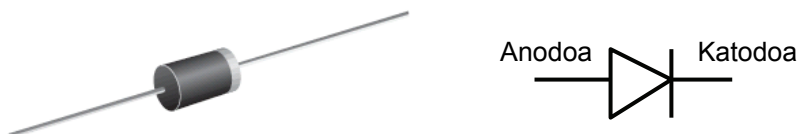
3.1 Irudia: Diodoa kapsula zilindrikoarekin (ezkerra), eta elementuaren sinboloa (eskuma). Kapsulako eraztunak katodoaren kokapena adierazten du.
