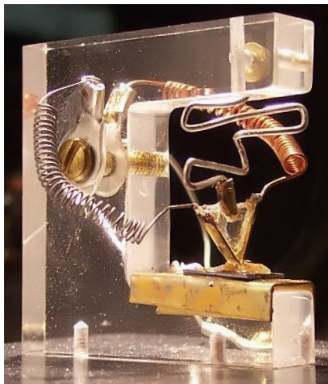
5.1 Irudia: Bardeenek eta Brattainek egindako lehen transistore bipolarra. Puntazko transistorea zen: erdiko germanio-kristalezko zati triangeluarrak metalezko kontaktu bi presionatzen ditu.
