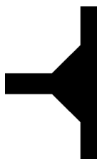
7.17 irudia. 90ºko pisten konexiorako irizpidea (xehetasuna).
