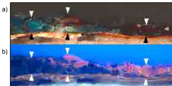
Figura 45. Estratigrafía de la decoración pictórica final (entre flechas) de la muestra V6Db: a) en luz normal se detecta en el extremo izquierdo el estrato de azurita, en la parte central azurita cubierta con pocas partículas traslúcidas de colorante orgánico rojo y en el extremo derecho el estrato de corladura roja con mayor cantidad de partículas rojas traslúcidas; b) en luz ultravioleta (UV) se observa mejor la transición (de izquierda a derecha) de la capa azul de azurita a la capa de corladura roja. Al igual que sucede en la figura 43 (y exclusivamente en el retablo de Bidaurreta), la superposición de dos estratos de pintura es indicativo de la transición de un estrato de color a otro estrato de color diferente.
