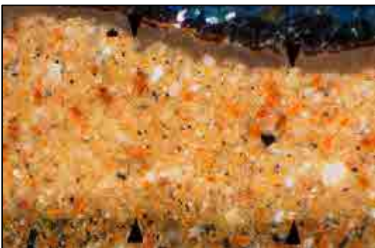
Figura 22. Estratigrafía de la masa de relleno (entre flechas) de la muestra I11Ab en luz normal compuesta fundamentalmente por blanco de plomo, negro de carbón, tierra roja rica en óxido de hierro y azurita.
