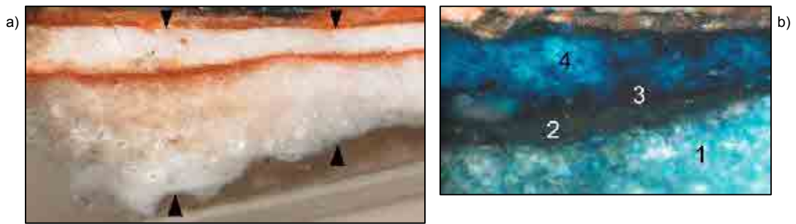
Figura 7. Estratigrafía de la preparación de la muestra V6Ca(2): a) en luz normal se aprecia la preparación (entre flechas) que consta de un estrato inferior de yeso grueso, un estrato intermedio de color naranja y un estrato superior de yeso fino; b) en luz normal y después de aplicar el reactivo para proteínas Negro de Amido 2, la preparación se tiñe de azul desvelando que tanto el yeso grueso (1) como el estrato naranja (2) como el yeso fino (4) utilizan como medio aglutinante cola proteínica y que la capa naranja está sellada con una mano de cola (3).
