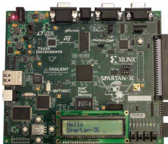
3.1. Irudia: Garapenerako erabili den Xilinxen Spartan3E Starter Kit txartela.
