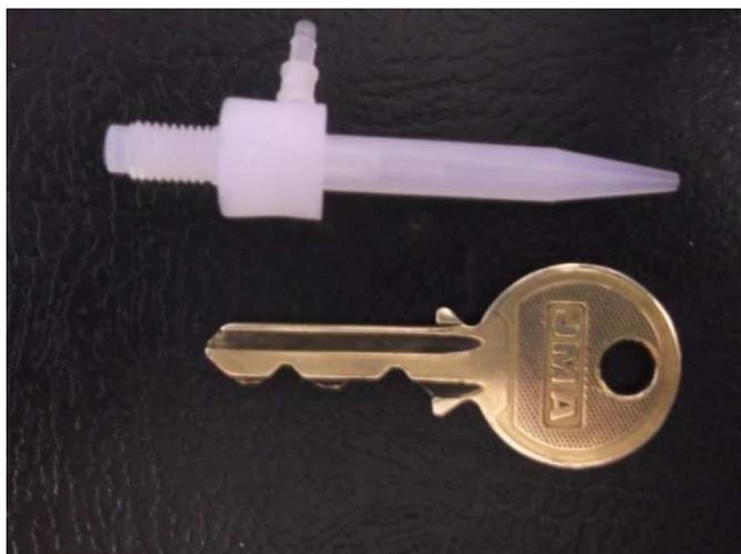
Foto III.3. Micronebulizador concéntrico de bajo flujo
