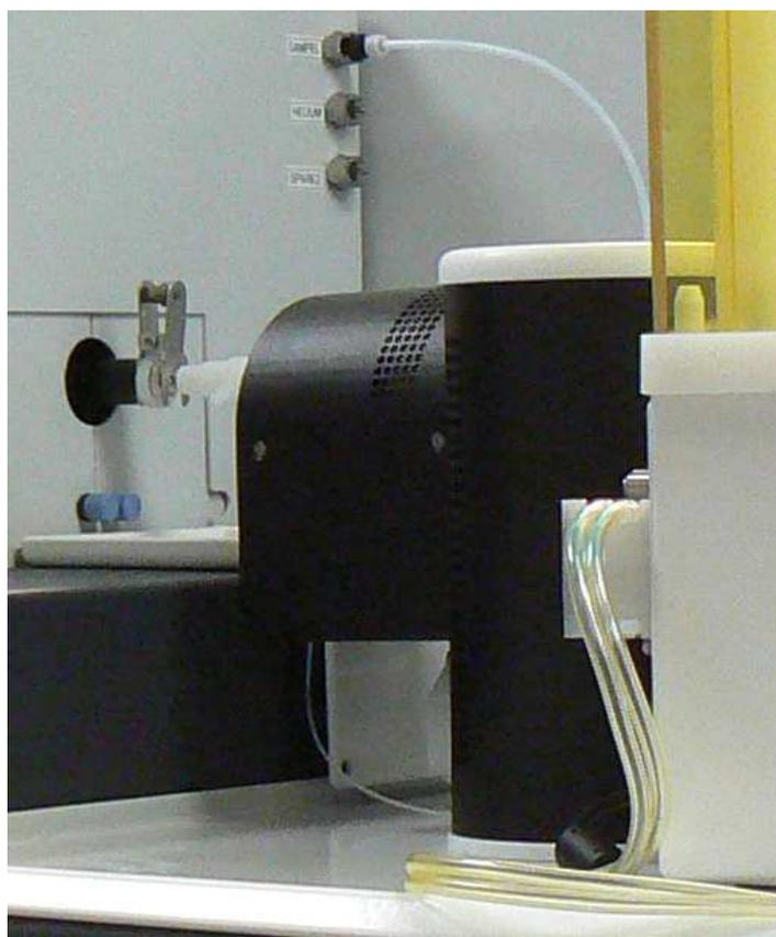
**Foto III.2.** Sistema de doble desolvatación Apex-Spiro
