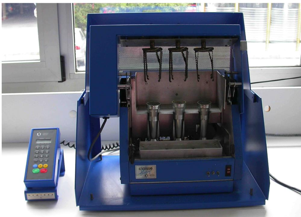
**Foto II.6.** Perladora Claisse Claisse Fluxy 30 utilizada en los experimentos.
