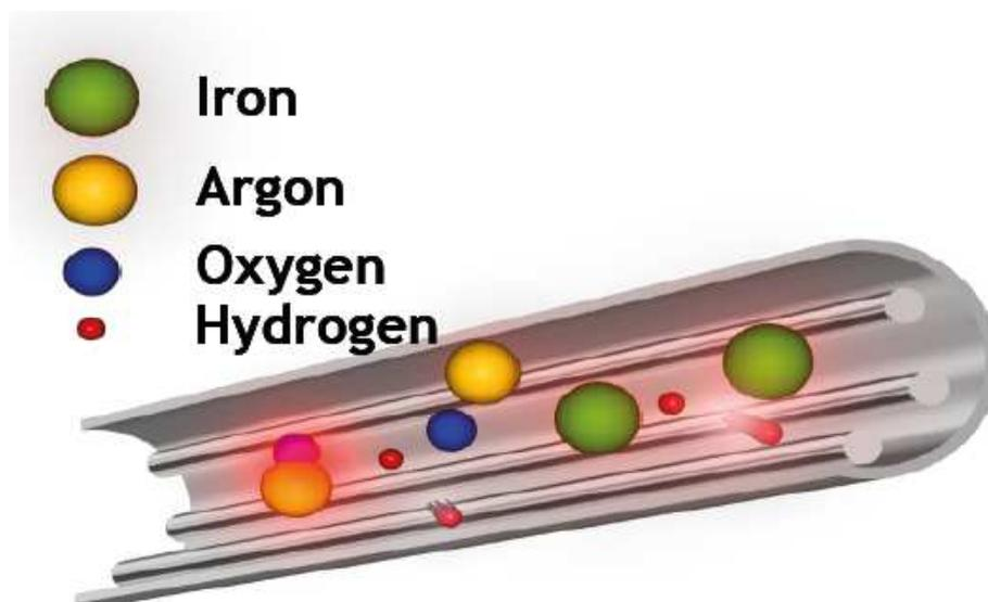
Figura II.4. Esquema de la celda de colisión.
