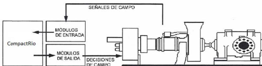
FIG 5.10 Diagrama de entradas y salidas Compact Rio Turbina [5]
