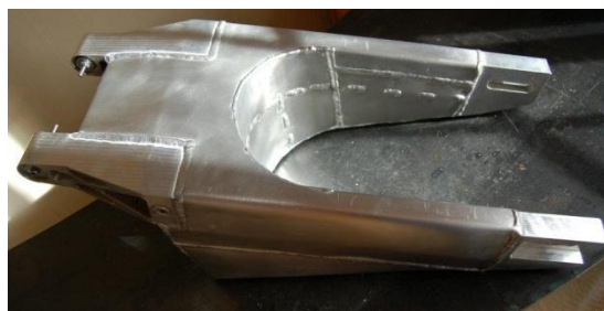
Figura 121. Basculante de aluminio soldado.
