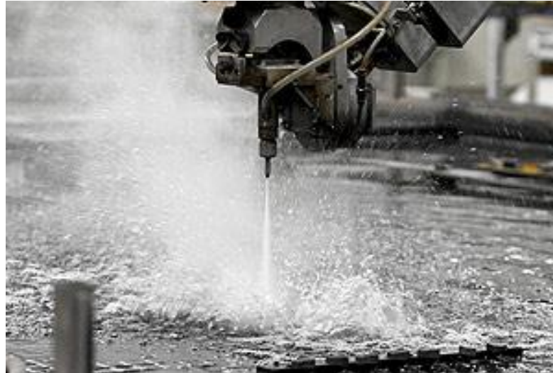
Figura 152. Proceso de corte por agua.
