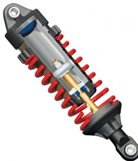
Figura 8. Ejemplo de amortiguador más muelle.
