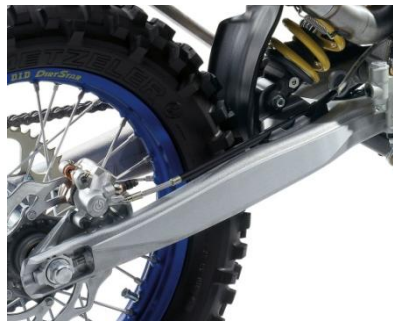
Figura 120. Basculante de aluminio hecho en fundición.
