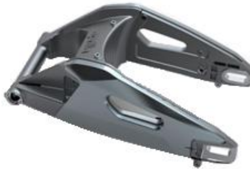
Figura 118. Basculante Doble brazo con sección triangular.
