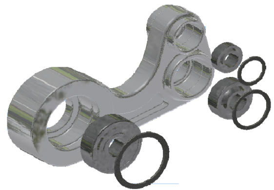
Figura 8. Montaje del triángulo de suspensión
