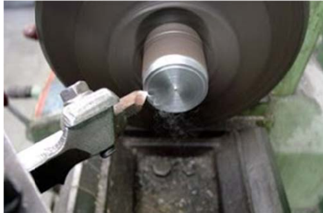
Figura 182. Proceso de desbastado.
