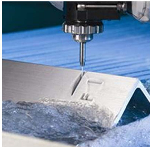
Figura 177. Proceso de corte por chorro de agua.
