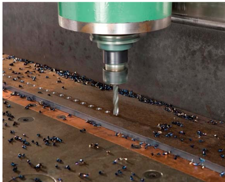
Figura 175. Proceso de taladrado.
