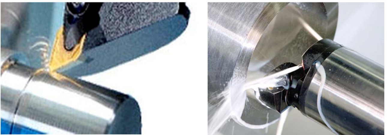
Figura 173. Proceso de torneado exterior y proceso de torneado interior.
