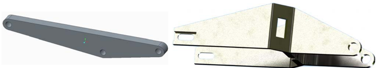
Figura 190. Desarrollo en el diseño del basculante
