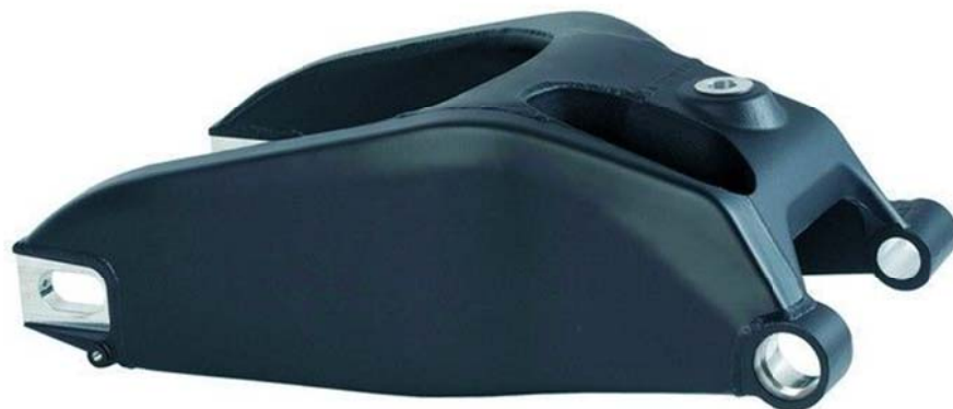
Figura 136. Basculante doble brazo de sección variable.
