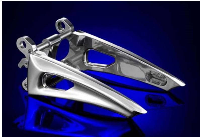
Figura 137. Basculante doble brazo triangulado.
