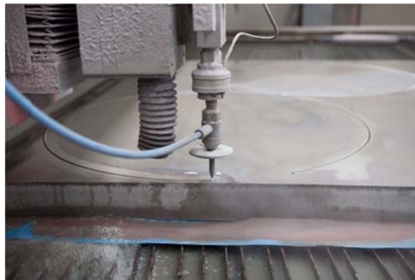
Figura 181. Corte por chorro de agua.
