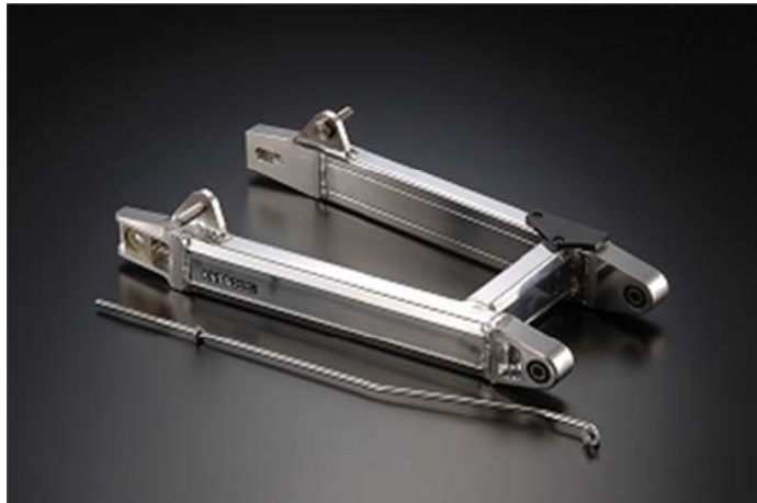
Figura 135. Basculante doble brazo
