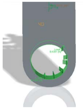
Figura 167. Cargas aplicadas en las orejas
