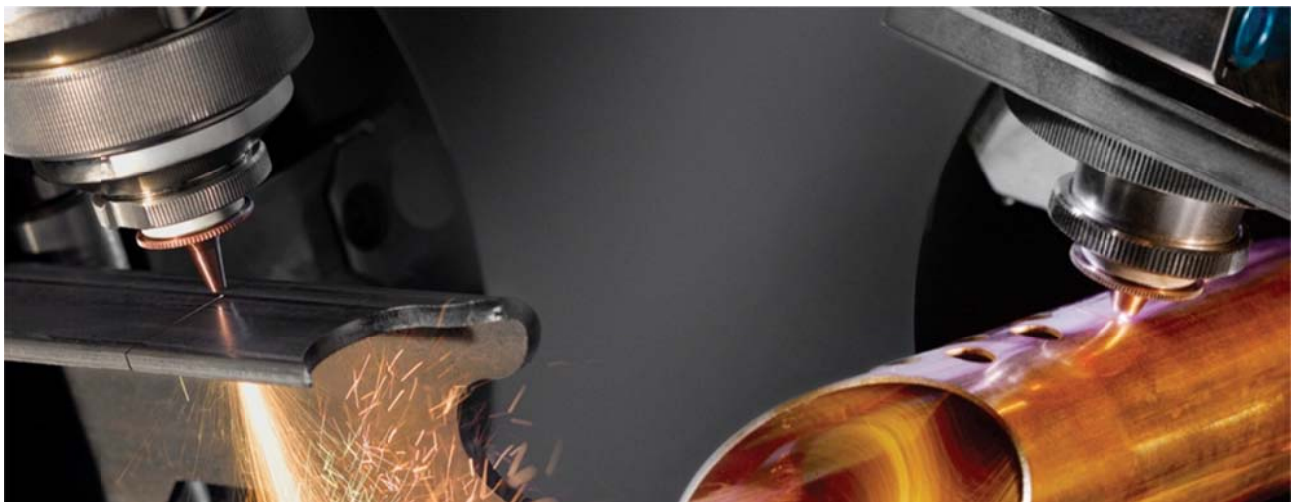
Figura 178. Proceso de corte por láser.
