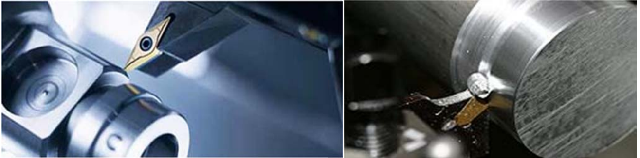
Figura 172. Proceso de acabado y proceso de desbaste.
