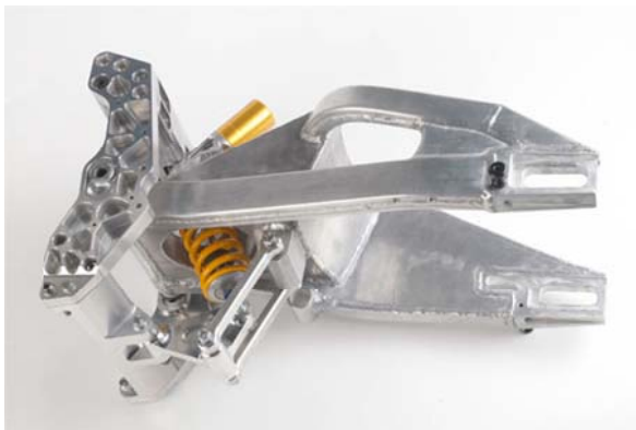
Figura 2. Suspensión trasera con sistema de bieletas
