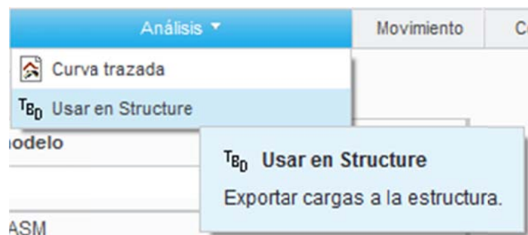
Figura 32. Opción válida para exportar los valores de las reacciones en cada punto de conexión de forma íntegra
