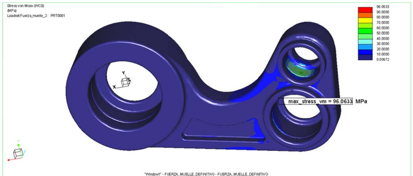
Figura 3. Tensiones introduciendo la fuerza del resorte.
