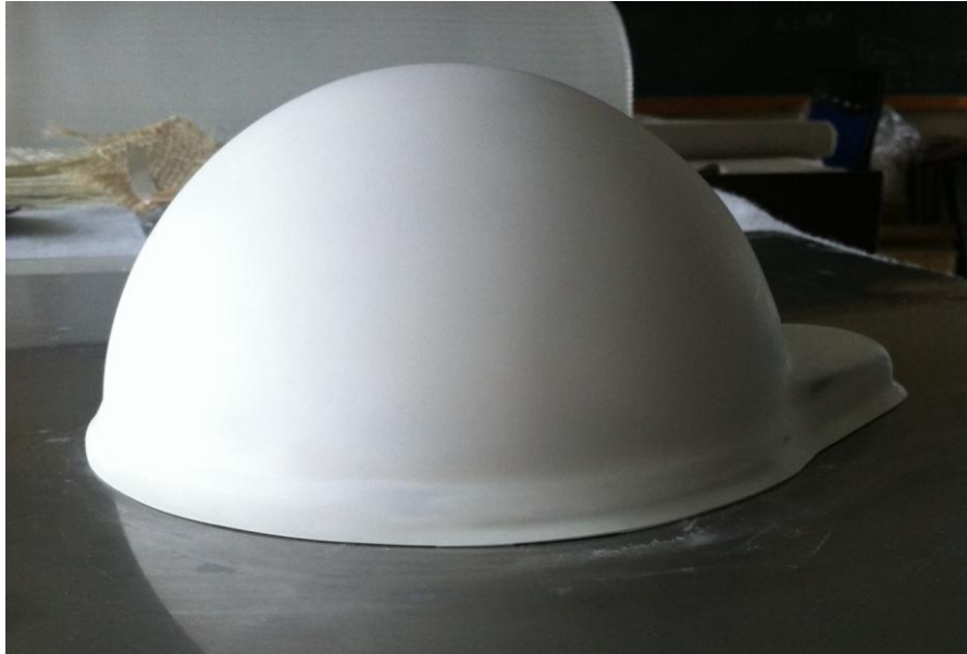
Figura 8. Pieza con 4 capas de polifondo preparada para laminar
