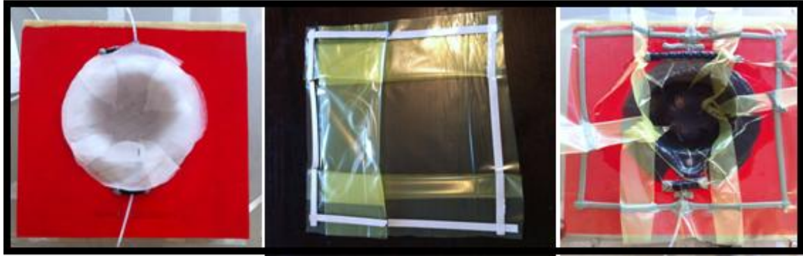
Figura 20. Método 2 para la construcción de la bolsa de vacío
