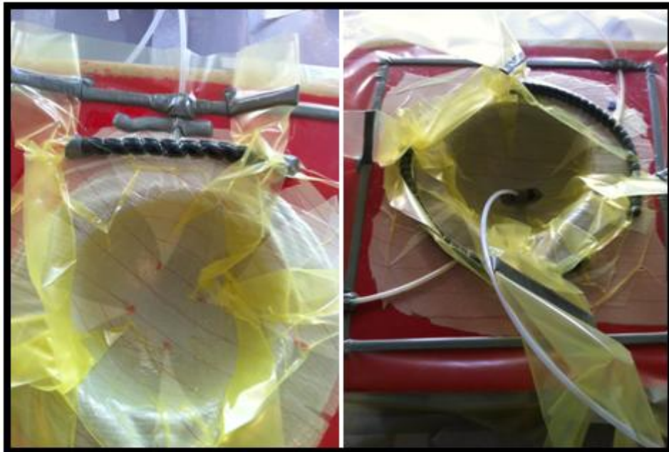
Figura 24. Prueba de vacío en los dos métodos de infusión.
