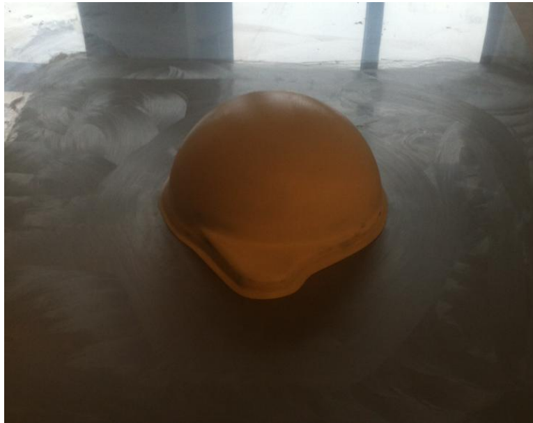
Figura 10. Boya y placa preparada con desmoldeante para el laminado manual
