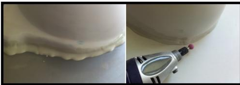
Figura 9. Mecanizado de la unión entre el modelo y la base
