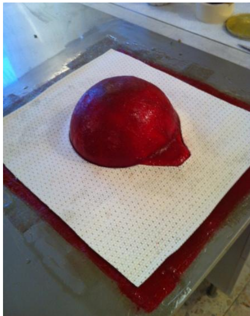
Figura 13. Aplicación del nido de abeja para dar rigidez al molde.
