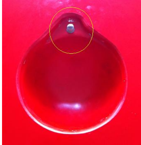
Figura 16. Cilindro de silicona para el agujero de la boya.
