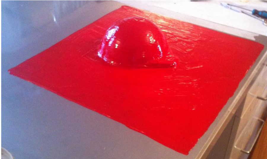
Figura 11. Aplicación de la capa del gelcoat rojo de moldes.
