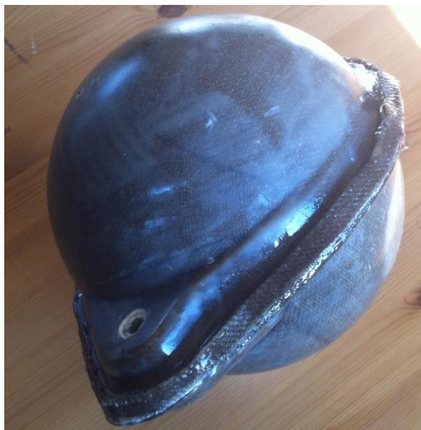
Figura 26. Boya marina final de biocomposite
