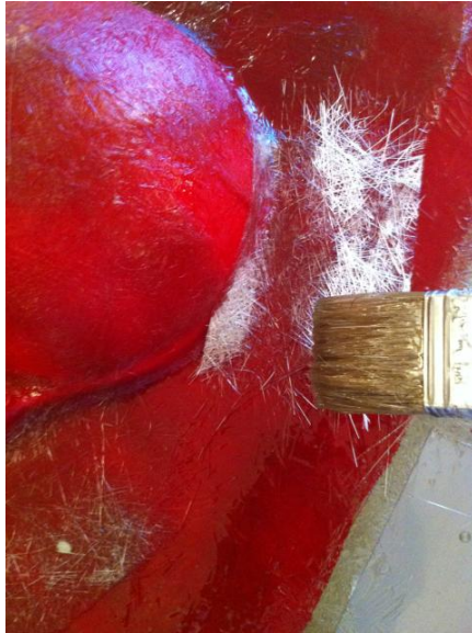
Figura 12. Aplicación de la primera capa de fibra de vidrio “mat”
