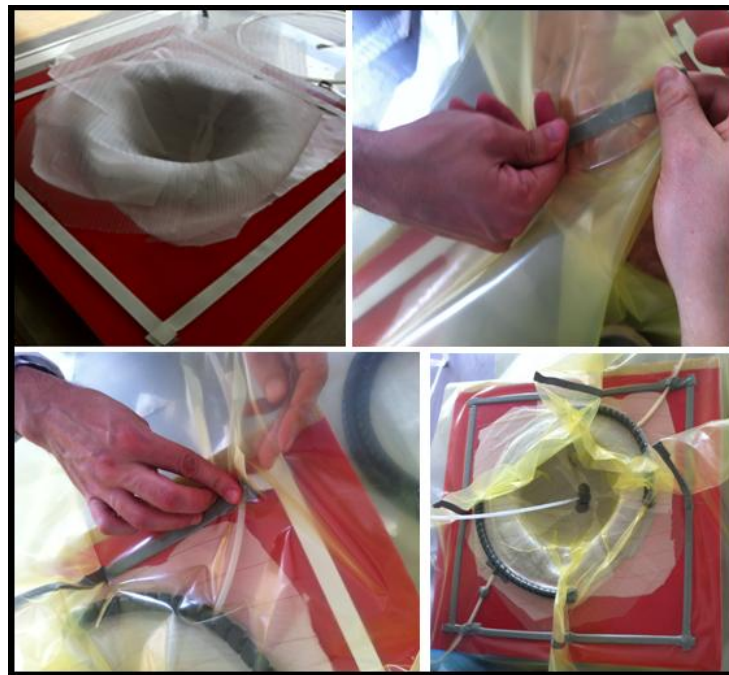
Figura 19. Método 1 para la realización de la bolsa de vacío
