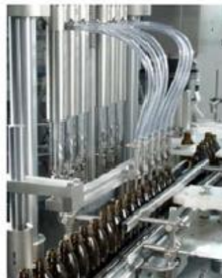
Proceso de llenado con pipetas automáticas.
