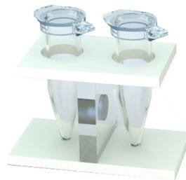
**Figura 3:** Imagen del Rack de separación magnética
