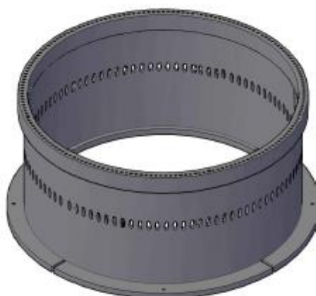
Figura 27. Virola de cimentación
