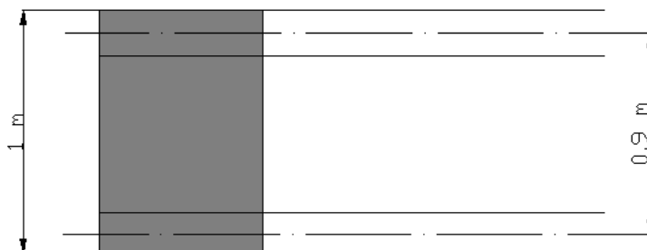
Figura 13. Vista superior del contrapeso y parte de la contrapluma.
