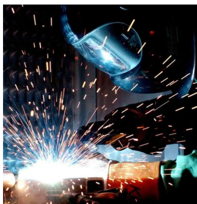
Figura 85. Soldadura por arco eléctrico.
