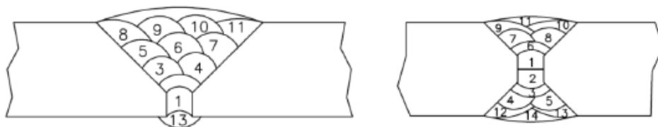
Figura 6. Recomendaciones para la ejecución de soldaduras de cordones múltiples.
