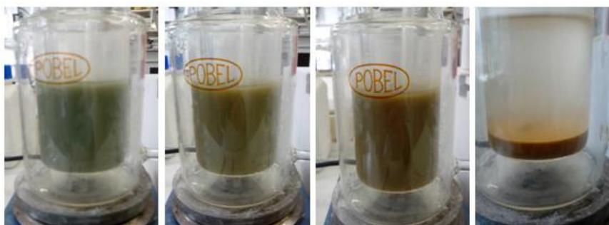
*Figura 3.6. Cambio de color experimentado en la síntesis de lepidocrocita soportada sobre arcilla en el reactor.*
