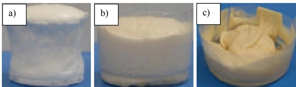
*Figura 17. Imágenes del polirol tras la espumación a) polirol virgen, b) 33% de sustitución y c) 50% de sustitución.*
