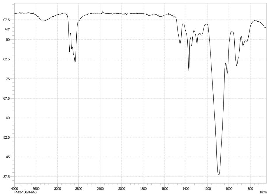
*Figura 15. Espectro FTIR del polirol comercial.*
