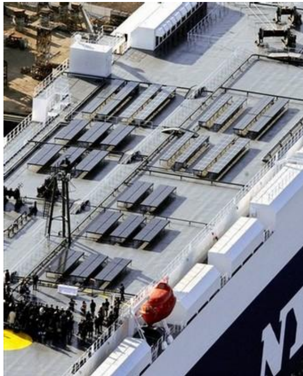
Figura 1. Cubierta del RO-RO "AURIGA LEADER" con los 328 paneles solares.[1]
