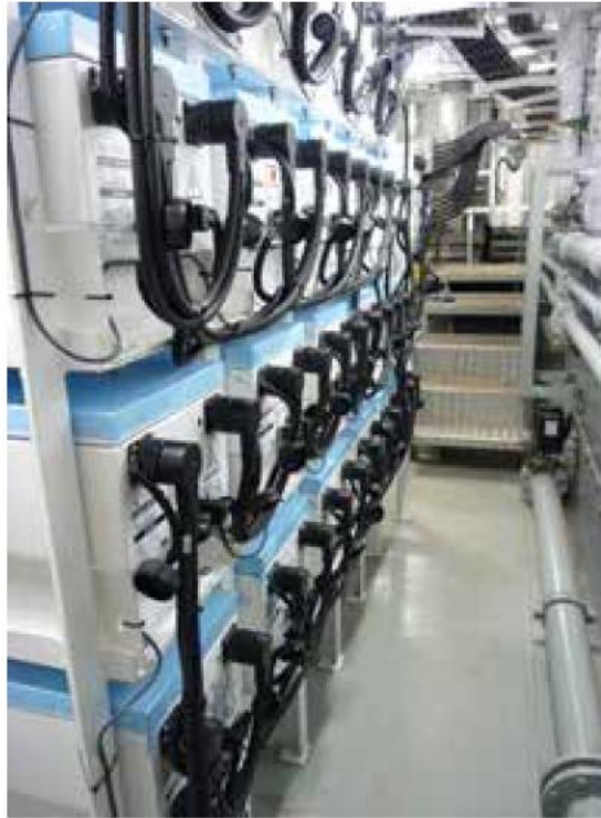
Figura 14. Baterías de litio a bordo del " EDDA FERD ".[39]
