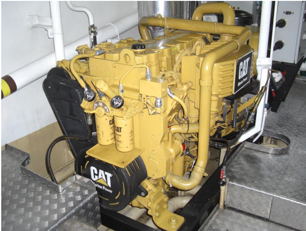
Figura 24. Motor auxiliar o generador del costado de babor del remolcador portuario tomado como referencia para el estudio.[64]
