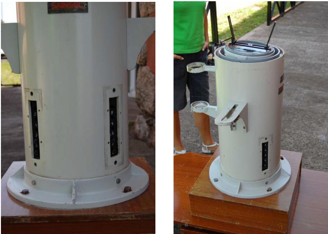
Figura 40. Casilleros de los imanes longitudinales y transversales [1]
