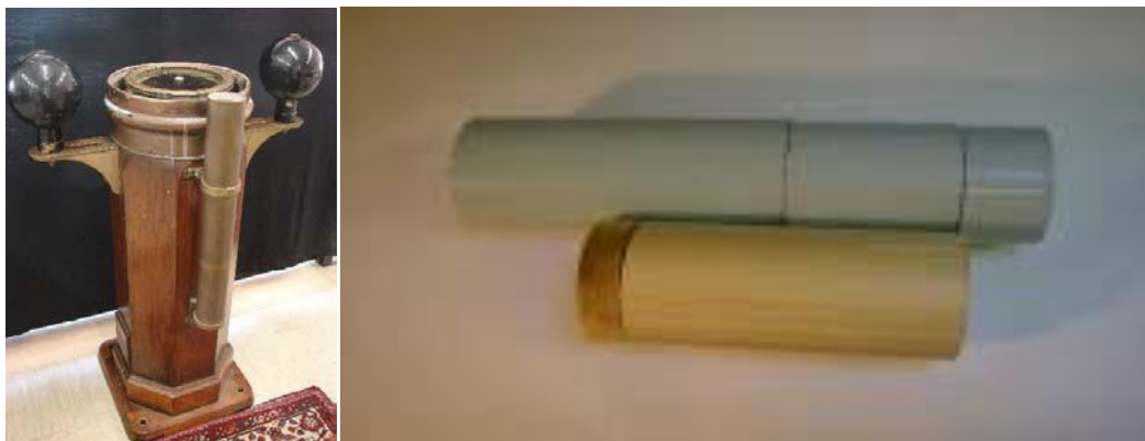
Figura 46. Barra Flinders a proa del compás (izq.) Hierro dulce y tacos de madera complementarios (dcha.) [1]
