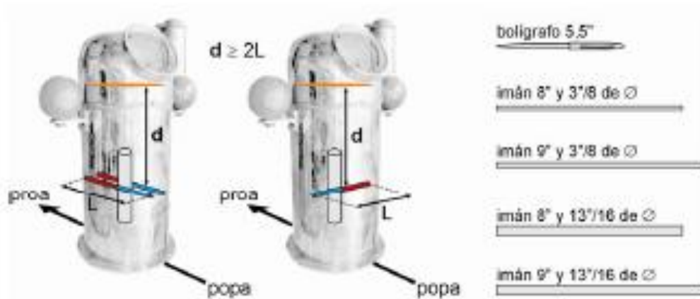
Figura 43. Distancia mínima a la que deben estar los imanes respecto al sistema de agujas va en función de la longitud de estos ( d > 2L ). [1]
