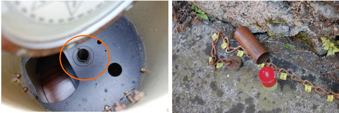
Figura 45. Ubicación del imán de escora en la bitácora (izq.). Estuche con su cadena graduada e imán (dcha.) [1]
