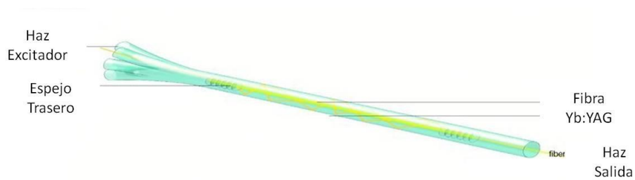
Fig.4.13 Esquema de láser de fibra
