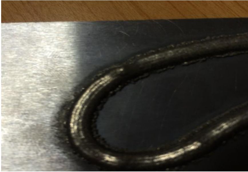
Fig.6.8. Detalle del “menisco” en el cambio de trayectoria
