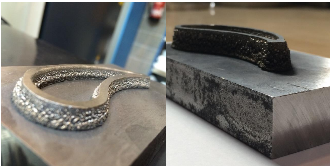
Fig.6.10. Detalle del crecimiento del álabe.
