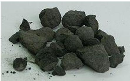
Clinker: producto del horno que se muele para fabricar el cemento.
