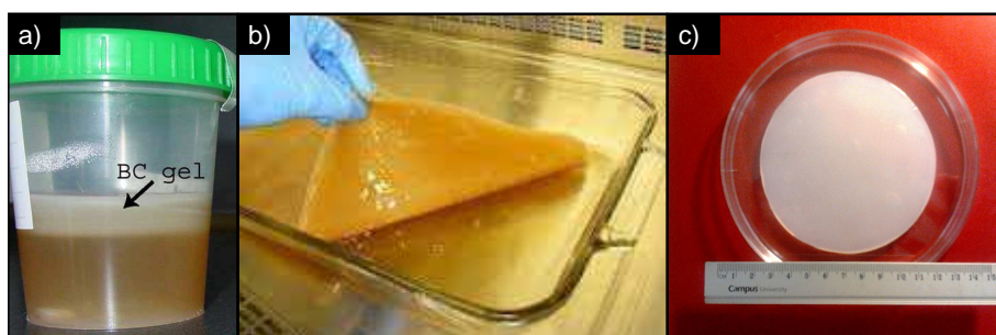
1. Irudia. a) zelulosa geruza aire-kultibo interfasean, b) ZB gel-ehuna bat eta c) ZB garbitasun prozesuaren ondoren.
