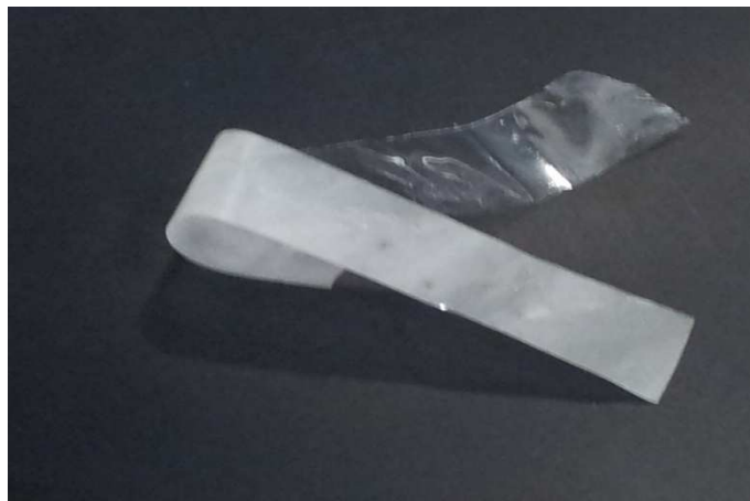
2Ir. % 80 PVA-% 20 \beta lg konposizioko filma. M_w altuko PVA erabiliz eta \beta lg-ren desnaturalizazio-prozesua aplikatuz. Film gardena pH 2.5rekin lortu da eta zurixka pH 5.5ekin.
