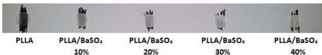
1. Irudia. PLLA/BaSO 4 sistemaren %0,10,20,30 eta 40-ko konposizioak.
