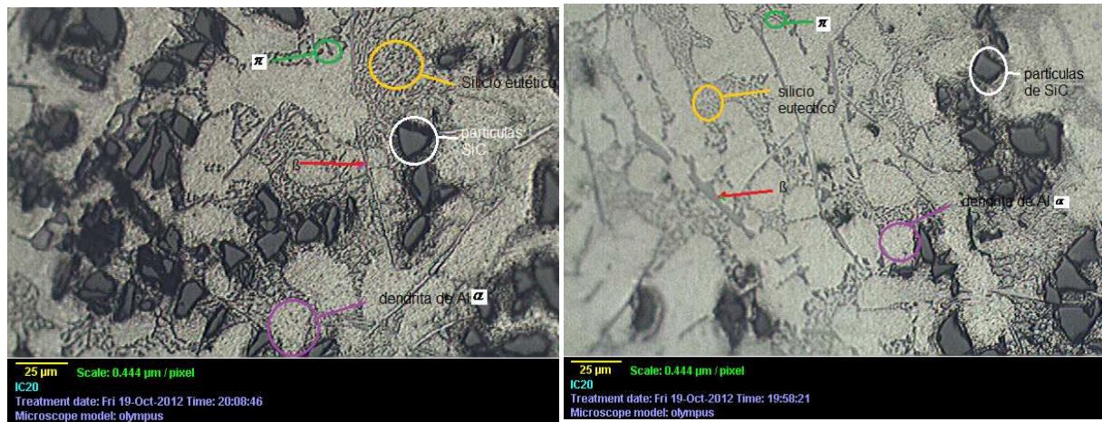
1 Irudia. a) A359-10% SiC eraldatugabeko egitura, 200X. b) A359-10% SiC eraldatuaren egitura, 200X. bi mikroegiturek \pi - \text{Al}_8\text{Mg}_3\text{FeSi}_6 intermetalikoa (berdez), \beta - \text{Al}_5\text{FeSi} phase (gorriz), SiC partikulak (txuriz), borobildutako silizio-eutektikoa (horiz) eta \alpha -aluminioa (urdinez) agerian dute.
