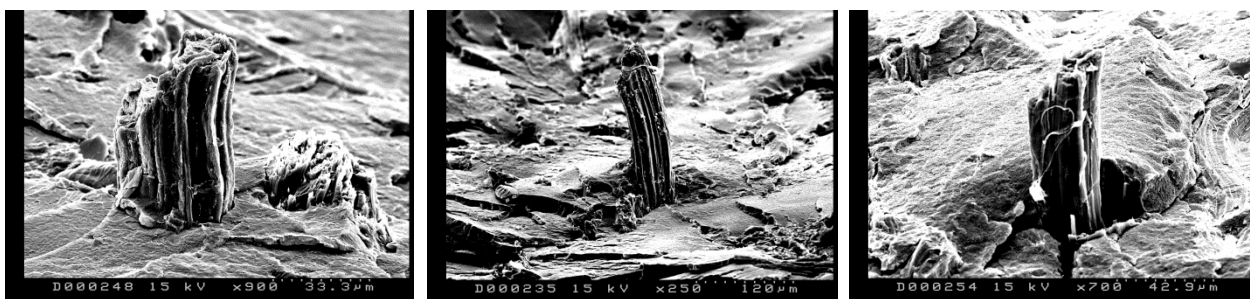
3.Ir.: Ezkerretik eskuinera, A, B eta C konpositeen SEM irudiak.
