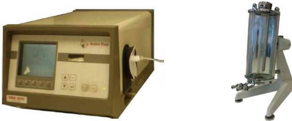
1. Irudia. Anton Paar DMA 5000 dentsimetroa (ezkerrean) eta Haake biskosimetroa (eskuinean).
