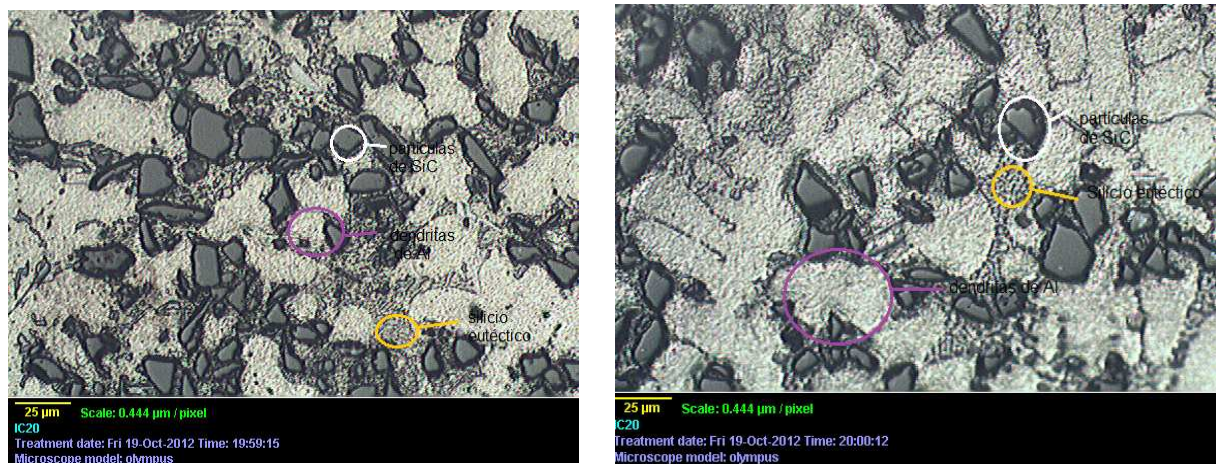
2.Irudia. a) A359-20 wt. % SiC eraldatugabeko egitura, 200X . b) A359-20 wt. % SiC eraldatutako egitura, 200X. Bi egiturek honako faseak dituzte: SiC partikulak (txuriz), borobildutako silizio-eutektikoa (horiz) eta \alpha -aluminioa (moratuz) (portzentai honetan burdin-intermetalikoak ez dira ikusten mikroskopio optikoarekin).
