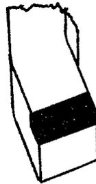
Fig. 4.10 Cuchilla de carburo metálico
