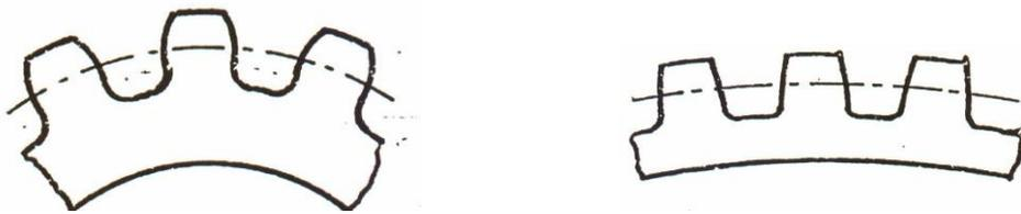
*Fig. 8.9 Perfil engranaje 15 dientes Fig. 8.10 Perfil engranaje 120 dientes*
