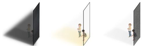
Fachada opaca (Sin luz) → Fachada transparente (sobrecalentamiento) → Fachada perforada (Luz uniforme)
