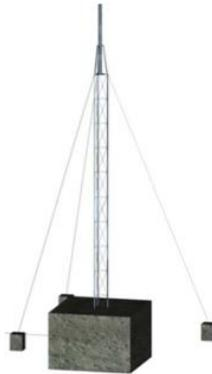
Figura 8.12 Detalle torre del aerogenerador P-750 14 m
