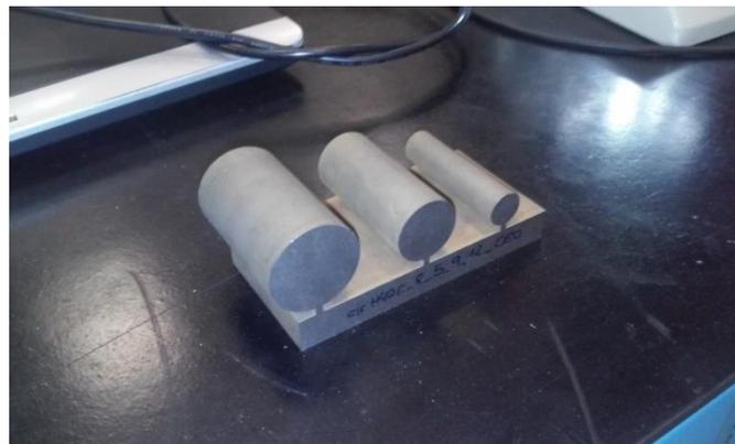
*Figura 3. Probeta de espesor 40 (H40) y radios 5, 9 y 12 mm.*
