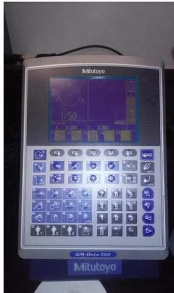
*Figura 8. Dispositivo de toma de puntos del proyector de perfiles.*
