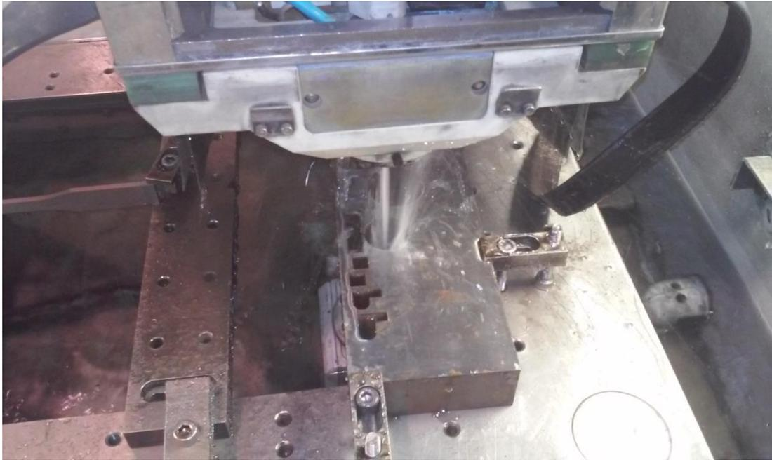
*Figura 6. Toma de contacto del hilo para proceder al inicio del corte.*
