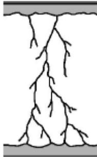
*Figura 3. Descarga ramificada en un medio gaseoso.*
