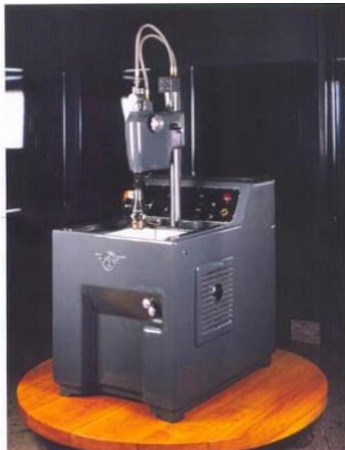
*Figura 1. Primera máquina ONA d electroerosión (1956)*
