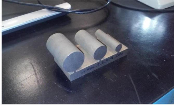
Figura 1. Probeta de espesor 40 (H40) y radios 5, 9 y 12 mm.
