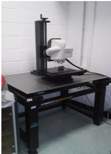
*Figura 11. Microscopio confocal Leica DCM 3D.*
