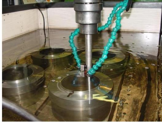
Figura 14. Mecanizado de acero Sverker 21 mediante electroerosión.
