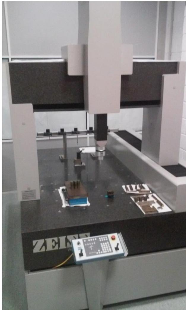
Figura 1. Máquina de medir por coordenadas Zeiss MC 850.
