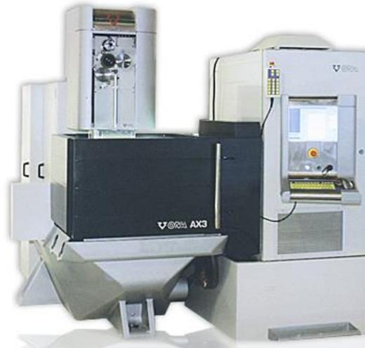
*Figura 4. Máquina de WEDM ONA AX3*
