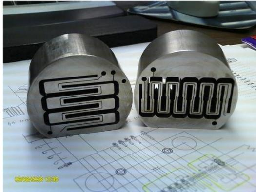
*Figura 15. Aleación Inconel 718 mecanizada mediante electroerosión por hilo.*
