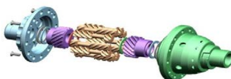
Figura 20: Despiece de un diferencial de deslizamiento controlado.
