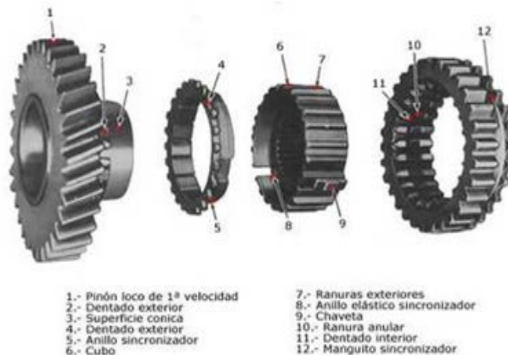
Figura 31: Despiece parcial de un sincronizador.
