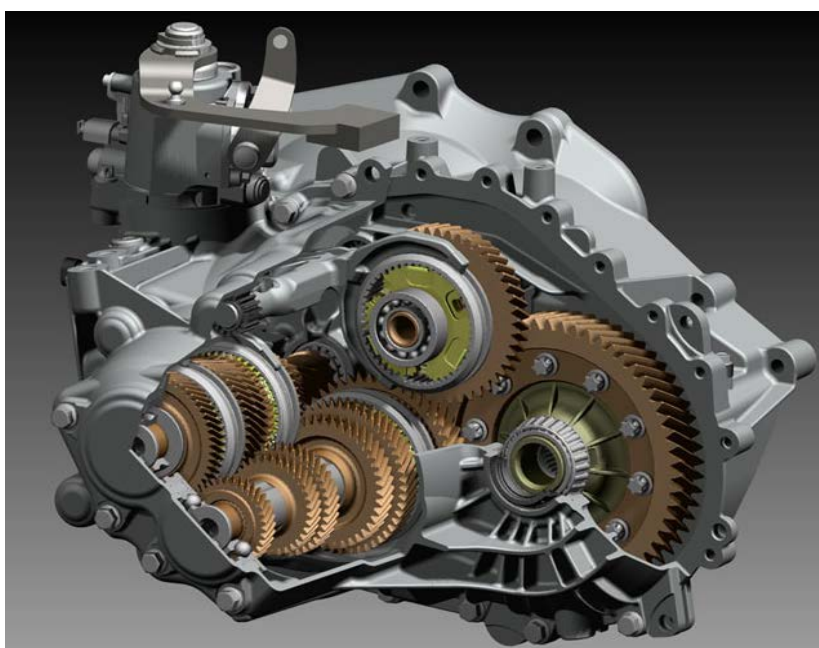
Figura 15: Caja de cambios manual robotizada o pilotada.
