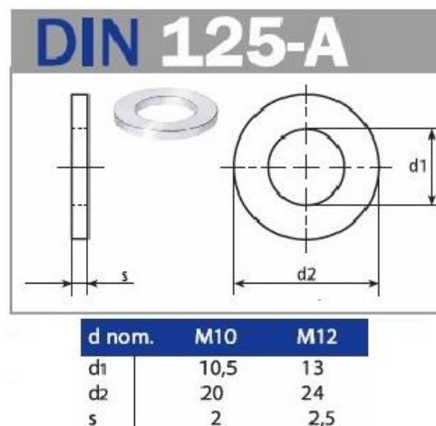
Figura 3.154. Arandelas DIN 125 a .
