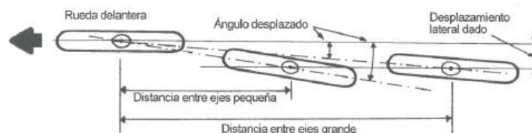
Figura 3.28. Desplazamiento de la rueda trasera [Pag. 3-15, MOTOCICLETAS Comportamiento dinámico y diseño del chasis, Tony Foale, David Sánchez, 2003]
