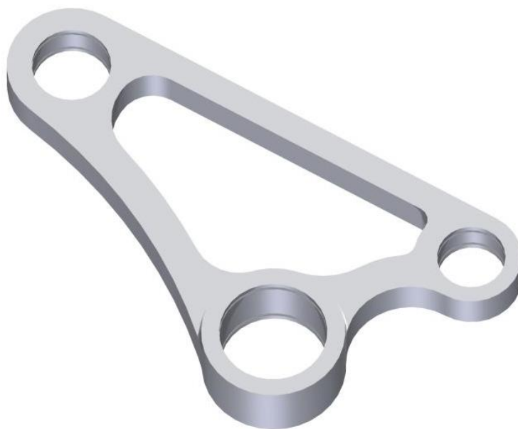
Figura 3.127. Diseño final del balancín.
