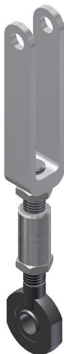
Figura 3.131. Diseño definitivo de la bieleta para su posición neutral: Longitud de 190mm.
