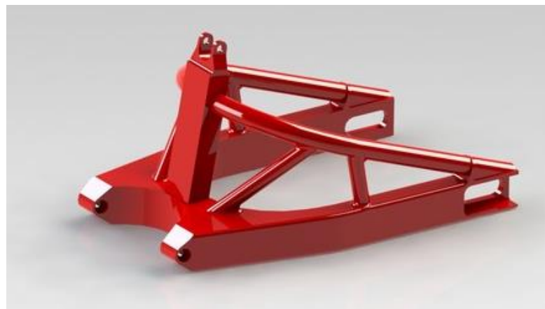
Figura 3.74. Mezcla de chasis mecanizado y tubular [GrabCad.com]
