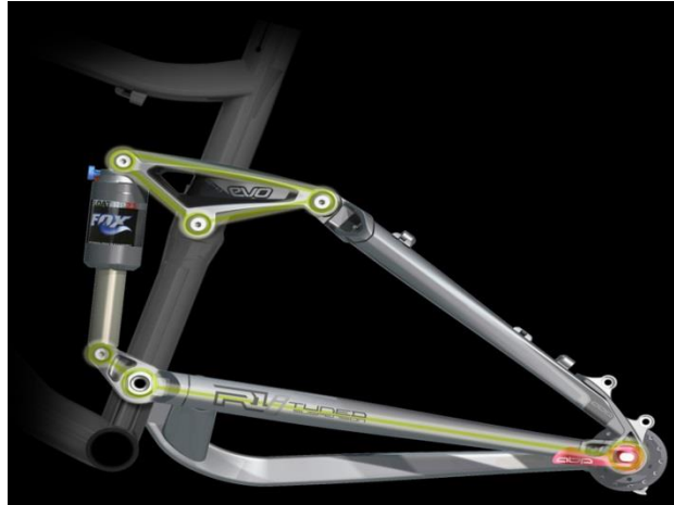
Figura 3.67. Anclaje del amortiguador por delante del punto de unión al chasis. Es una bicicleta, pero el concepto es casi idéntico para las motocicletas.
