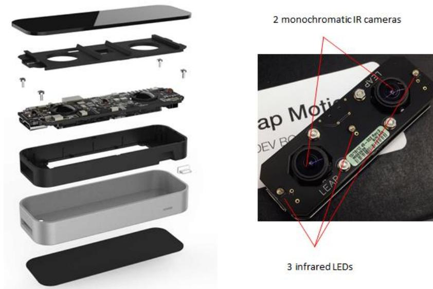
Figura 3: Componentes hardware del controlador Leap Motion
