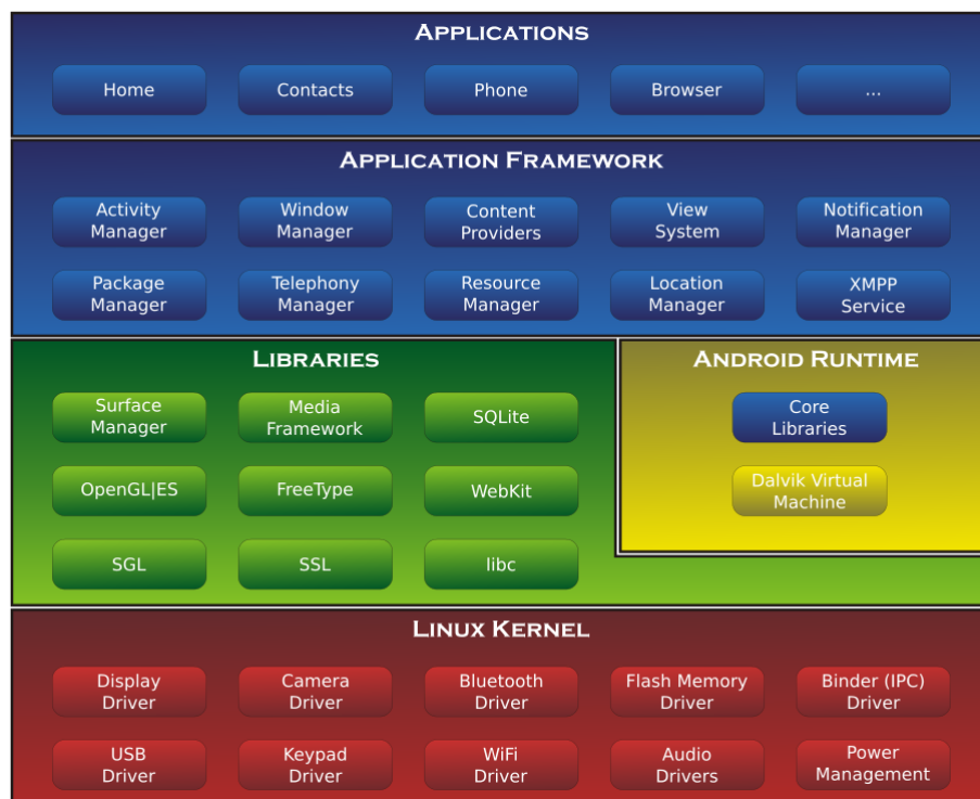
3.1 Irudia: Android sistema eragilearen arkitektura
