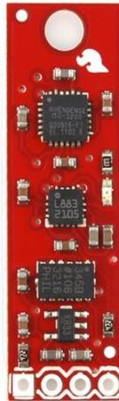
Figura 14: Unidad de Medición Inercial (IMU).
