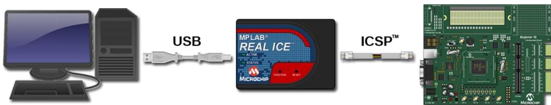
Figura 11: Diagrama de conexión para la programación del microcontrolador desde el PC utilizando la placa *Explorer 16*.
